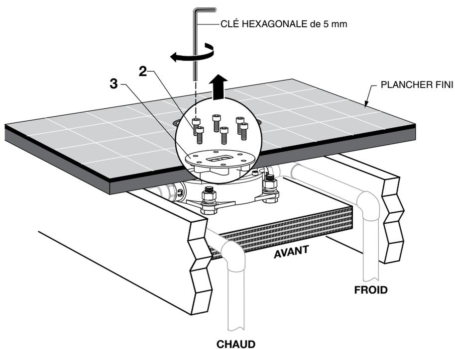
**3****RETRAIT DES VÉRIFICATEURS DE TENSION POUR EAU CHAUDE ET EAU FROIDE**
