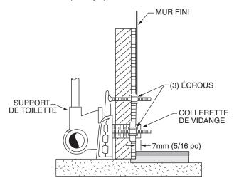
Avec un niveau, régler l'écrou de retenue en haut à gauche, de manière à ce qu'il soit sur le même plan vertical que l'écrou de retenue en bas à gauche.
