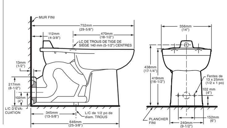
**DIMENSIONS (Nominale) REMARQUE : La distance depuis le sol au centre de la collerette de plancher (brut) doit être de 4 po (102 mm) avec la collerette arrivant à 1/16 po (1,6 mm) maximum hors du mur fini.**
