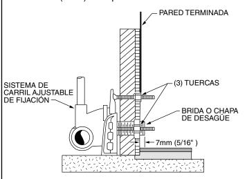
Con un nivel, ajuste la tuerca de retención superior izquierda de modo que esté en el mismo plano vertical que la tuerca de retención inferior izquierda.
