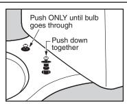
**NOTE: FLANGE MUST REMAIN ABOVE THE SURFACE.** DO NOT ALLOW GROMMET TO **FALL THROUGH!**
