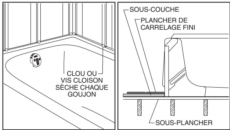
4 Ci-dessous sont illustrées des sections transversales caractéristiques du rebord de cuve démontrant les constructions typiques de murs.
