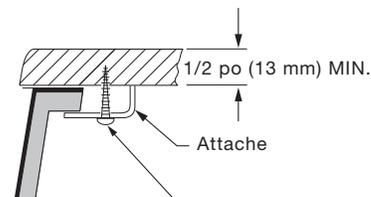
Percer au diamètre 3 mm (1/8 po) sur une profondeur de 10 mm (3/8 po).
