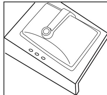
**REMARQUE :** Les vis inclus devront être utilisés avec des comptoirs qui sont 1 po (25.4 mm) en épaisseur. Pour des comptoirs plus mince, utiliser des ancrs et attaches appropriés.
