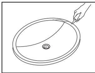
**REMARQUE :** Ne utilisez pas des adhésifs ou des collants. Après vérification de l'ajustement et du centrage du lavabo sur l'ouverture, appliquer un trait d'adhésif au silicone sur le rebord du lavabo.
