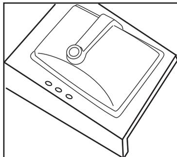
**REMARQUE :** Les vis inclus devront être utilisés avec des comptoirs qui sont 1 po (25.4 mm) en épaisseur. Pour des comptoirs plus minces, utiliser des ancrages et attaches appropriés.
