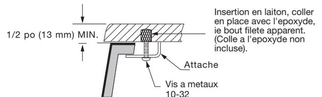
Insertion en laiton, coller en place avec l'époxyde, le bout fileté apparent. (Colle à l'époxyde non incluse).
