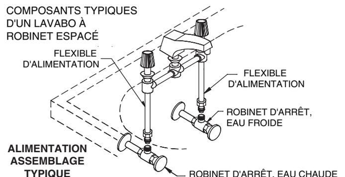
4. Boulonner sans serrer le lavabo au mur. Afin de protéger la céramique et le plancher des éraflures, apposer un coussinet adhésif oufeutre similaire à chaque extrémité de les jambes, ce qui empêchera également le lavabo et les jambes de s'entrechoquer en assurant un meilleur contact entre le lavabo et les jambes. ÉVACUATION – ASSEMBLAGE TYPIQUE
