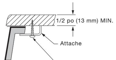
Perçer au diamètre 3 mm (1/8 po) sur une profondeur de 10 mm (3/8 po).
