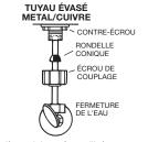
Ces pièces doivent être utilisées comme illustré afin d'assurer un raccordement étanche. L'utilisation de l'écrou de couplage existant pourrait causer des fuites d'eau. La conduite ou le tuyau d'alimentation d'eau doit pénétrer d'au moins ½ po (13 mm) dans la tige filetée de la vanne (ne concerne pas la canalisation jointée).
