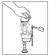
Ouvrir et fermer l'alimentation d'eau à quelques reprises tout en maintenant le contenant au dessus de la valve dont le capuchon est enlevé, pour éviter d'être éclaboussé. Laisser l'alimentation d'eau fermée.
