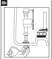
Lorsque les rondelles appropriées sont en place (Étape 8a), serrer l'ÉCROU DE COUPLAGE de 1/4 de tour de plus.
