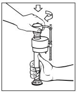
Introduire les languettes et tourner de 1/8e de tour dans le sens horaire pour reposer le CAPUCHON. VÉRIFIER QUE L'EMBOUT EST TOURNÉ EN POSITION VERROUILLÉE. SI LE CAPUCHON N'EST PAS COMPLÈTEMENT SUR LA POSITION VERROUILLÉE, IL SE PEUT QUE LA VALVE NE PUISSE S'OUVRIR.
