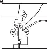
Ouvrir l'alimentation d'eau. Plonger le FLOTTEUR sous l'eau pendant 30 secondes. Régler le niveau de l'eau en tournant la TIGE DE RÉGLAGE DE NIVEAU D'EAU et en faisant monter et descendre le FLOTTEUR.
