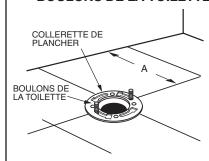
Passer les boulons de la toilette dans les ouvertures de la collerette, tourner de 90° pour les glisser en place à 6 po (152 mm) d'écart entre eux et parallèles au mur.
