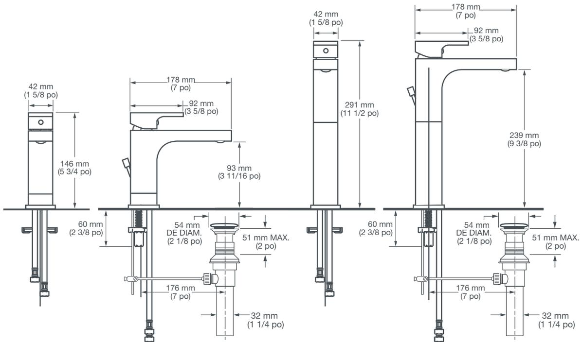
REMARQUE : LES TROUS DE MONTAGE ONT UN DIAMÈTRE DE 35 mm (1-3/8 po)
