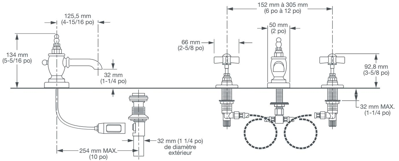
REMARQUE : Les TROUS DE MONTAGE ONT UN DIAMÈTRE DE 32 mm (1-1/4 po) pour le bec et pour la vanne latérale
