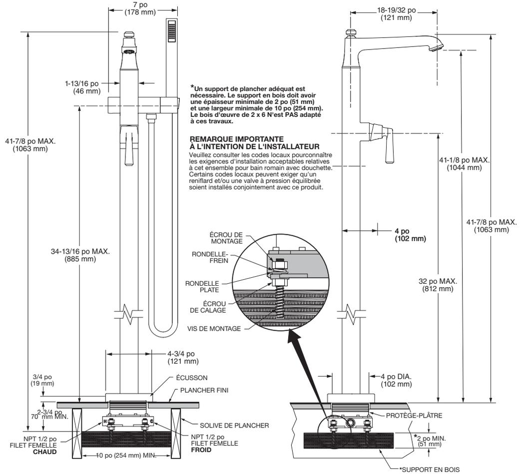
\*Un support de plancher adéquat est nécessaire. Le support en bois doit avoir une épaisseur minimale de 2 po (51 mm) et une largeur minimale de 10 po (254 mm). Le bois d'œuvre de 2 x 6 N'est PAS adapté à ces travaux.
