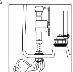
With correct washers in place, tighten COUPLING NUT 1/4 turn beyond hand tight. DO NOT OVERTIGHTEN. Ayan puesto las ronelles apropiadas resserre manuellement l'ECROU DE RACCORDEMENT de 1/4 de vuelta. EVITER DE TROP SERRER. Una vez que las arandelas estén colocadas apriete LA TURCA DE ACOPLAMIENTO 1/4 de vuelta después de apretar al máximo con la mano. NO APRIETE EN EXCESO.
